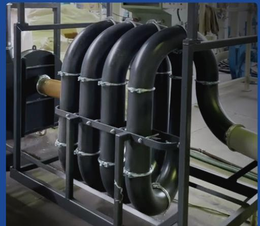
Ein Trockengranuliersystem von SIKOPLAST ist eine Lösung für Betriebe, die ihre Produktion mit überschaubarem Aufwand stabil halten möchten. Das Verfahren benötigt kein Prozesswasser, wodurch sich der technische Anspruch reduziert. Die Systeme sind so aufgebaut, dass sie Standardmaterialien und Regranulate sicher verarbeiten und eine konstante Schnittqualität liefern.
