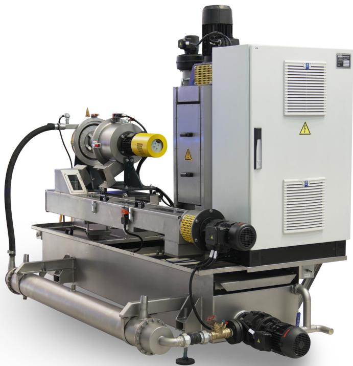
Nach der Abkühlung erfolgt eine mechanische Entwässerung, bevor das Material in der Zentrifuge vollständig getrocknet und für den nachfolgenden Prozess aufbereitet wird. Auf diese Weise entsteht ein sauber geformtes, homogenes Granulat, das sich ohne zusätzlichen Aufwand fördern, verpacken oder direkt weiterverarbeiten lässt.
